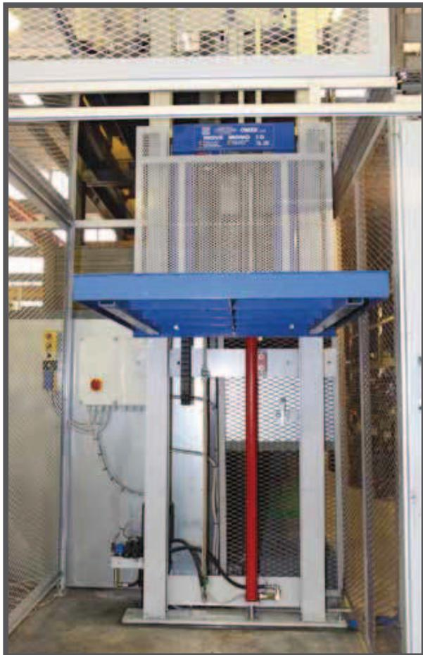
La gamma dei montacarichi di Omer SPA parte da una portata di 750 Kg fino ad arrivare ad una portata di 1.500 Kg. La struttura della macchina è, pertanto, adeguata alle necessità di sollevare pesi di consistenza elevata. **Di conseguenza si può dire che la gamma di montacarichi Omer SPA è prevalentemente industriale.**
