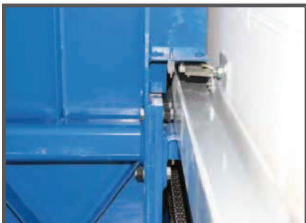
Si noti come la pedana, al passaggio sul fine corsa, aziona lo stesso che dà il comando di arresto.
