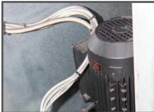
La centralina è composta da un serbatoio dell'olio, da un quadro elettrico e da una pompa idraulica. Il tutto occupa uno spazio non superiore al metro quadro, di facile accesso per la manutenzione ed il controllo.
