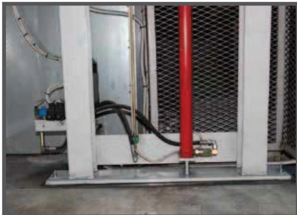
La struttura è composta da due colonne, saldate in un blocco unico, per dare ancor più rigidità alla struttura e da un cilindro centrale a funzionamento idraulico, di produzione Omer SPA ,collegato ad una centralina apposita.
