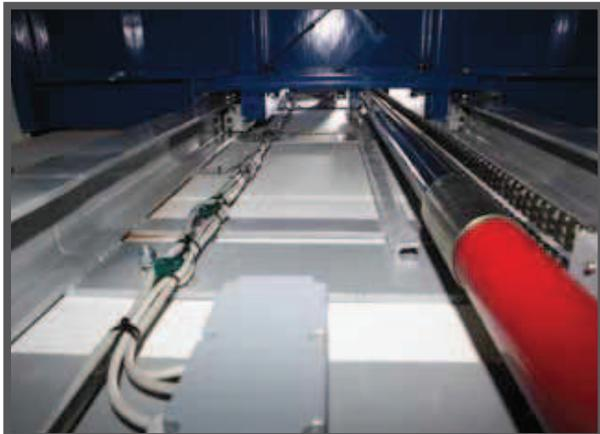
Tutta la parte principale della macchina è posizionata tra le due colonne, comprese tutte le connessioni elettriche e le scatole di derivazione. Tale posizionamento permette un facile accesso in caso di guasto o di manutenzione.
