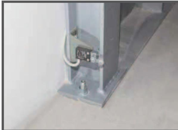
La macchina è dotata di fine corsa elettrici per il rallentamento della velocità e la relativa fermata. Tali sistemi sono regolabili in relazione alla sensibilità degli stessi.
